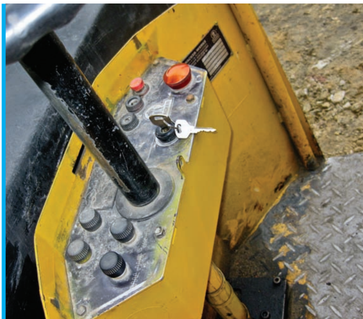
Fot. 46 Nie wolno pozostawiać urządzeń bez nadzoru z kluczykami w stacyjce.
